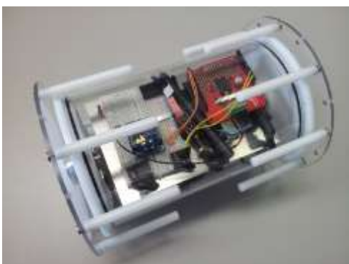
図1: ロッド型車輪機構による軟弱地盤移動用ロボット。
