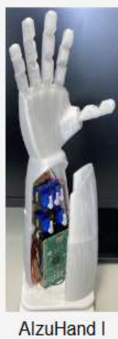
アダプティブリアルタイム非侵襲ニューロモルフィック義手。左：アプローチの全体像、右：AlzuHand I 義足初試作
