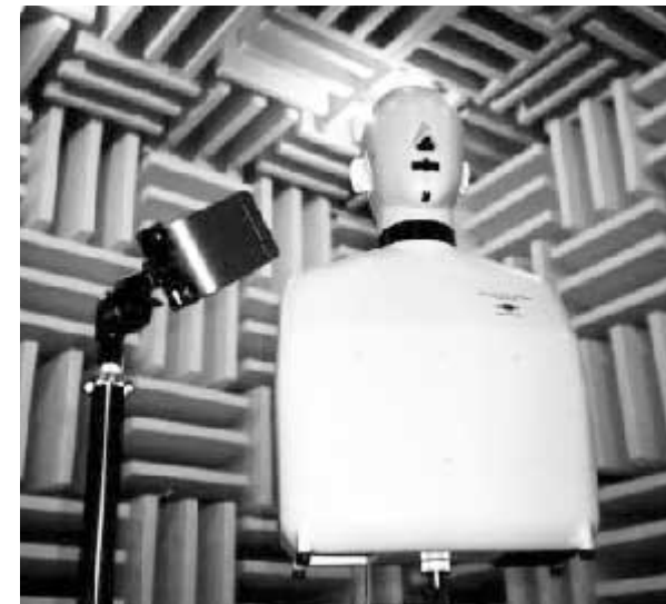
Figure:2 会津大学の無響室と Brüel & Kjær 社製のダミーヘッド。この写真は、ダミーヘッドでより近い音源における HRTF を実装するためにインパルス応答を記録しようとしているところです。
