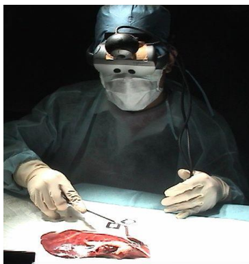
ミニ豚の肝臓の硬度測定 ヘッドマウントディスプレイには肝臓の映像と触感情報が重畳して表示される。
